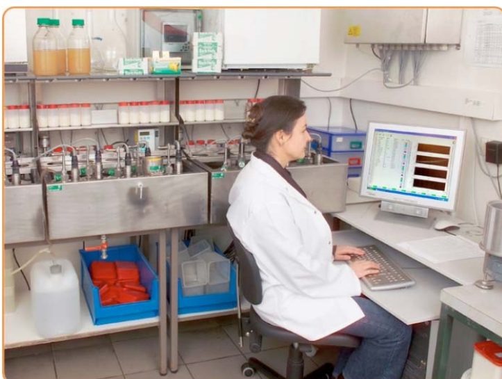
Abbildung 10: UNIFERM Triebkraftmessung am Standort Monheim am Rhein
